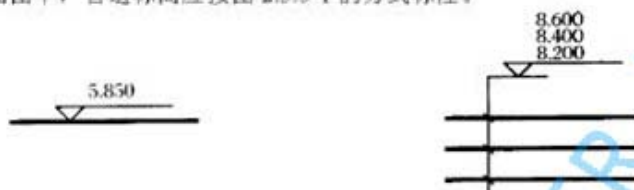
图 2.3.5-1 平面图中管道标高标注法
